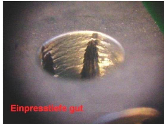
Die Einpressung ist zu tief, wenn sich auf der LP-Unterseite Aufwölbungen zeigen. Die maximale Tiefe ist erreicht, wenn die Kontaktspur mit dem Loch endet, bzw. bei großen Kontakten sich noch keine deutliche Aufwölbung der Kupferlage zeigt.
